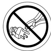
La rimozione dello spinotto di messa a terra può causare scossa elettrica. Se necessario, installare correttamente un adattatore autorizzato a 3 spinotti in una presa elettrica con accesso per spina a 2 spinotti. La mancata osservanza può causare lesioni alle persone e/o danni alle cose.
