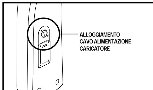
Figura 6. Alloggiamento Cavo Alimentazione Caricatore
