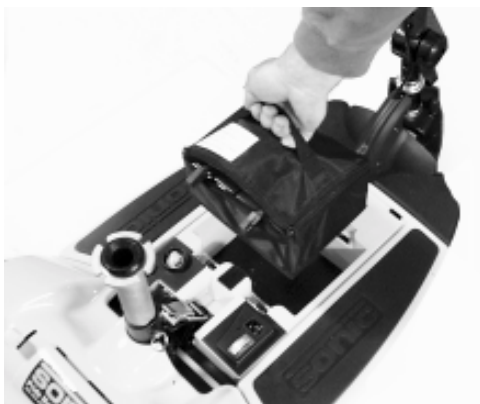
Figura 11a. Estrazione del pacco batterie
