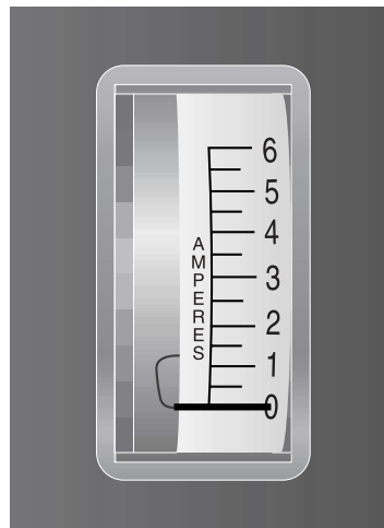
Figura 8A. Amperometro in posizione di carica completa
