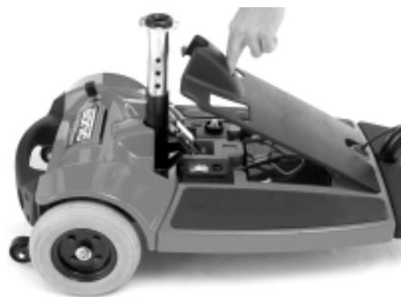
Figura 10. Coperchio vano batterie
