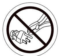
La rimozione dello spinotto di messa a terra può causare scossa elettrica. Se necessario, installare correttamente un adattatore autorizzato a 3 spinotti in una presa elettrica con accesso per spina a 2 spinotti.
