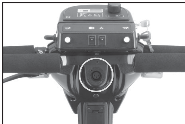
Figura 11. Alloggiamento Cavo Alimentazione Caricatore
