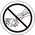
**No retire el contacto de tierra del enchufe para evitar cualquier riesgo eléctrico. Si su toma de corriente tiene únicamente 2 orificios, instale un adaptador de 3 contactos adecuado.**
