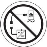
**No conecte cables de prolongación al convertidor CA/CC ni al cargador de batería.**
