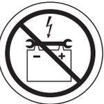
**Evite el contacto de herramientas y otros objetos metálicos con los terminales de batería. El contacto con herramientas puede producir descargas eléctricas.**
