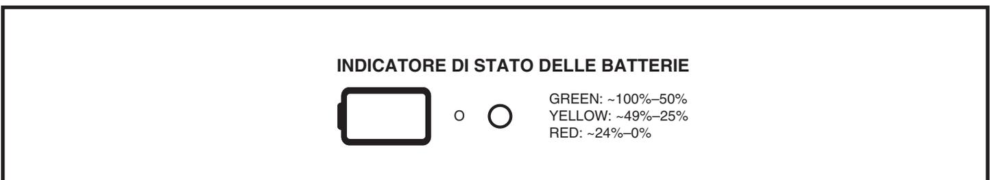
Figura 10. Indicatore di stato delle batterie
