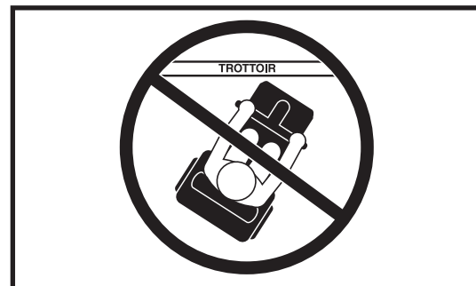
Figure 7. Approche incorrecte de trottoir
