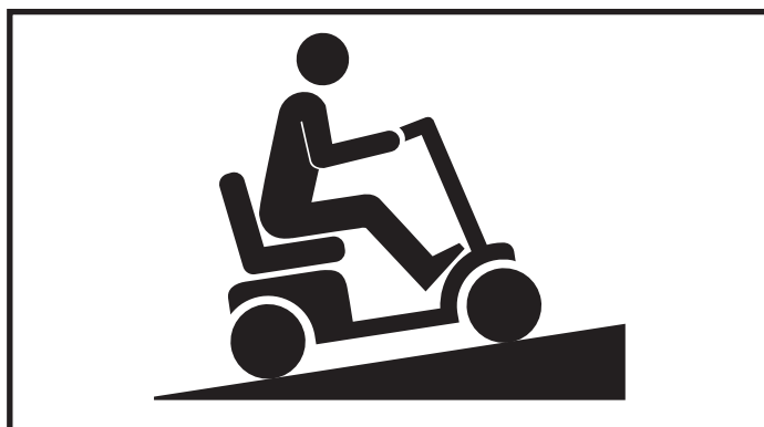
Abbildung 4. Fahrstellung für höhere Stabilität
