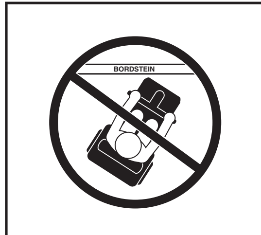
Abbildung 7. Falsches Anfahren eines Bordsteins
