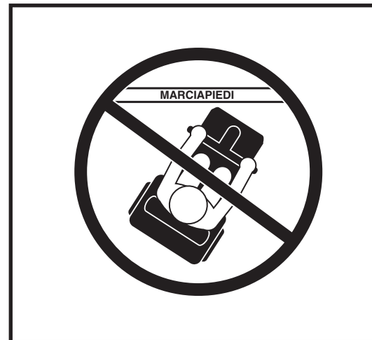
Figura 7. Approccio errato al marciapiede
