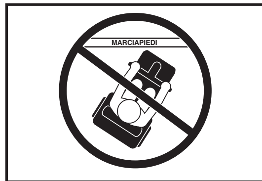
Figura 7. Approccio errato al marciapiede
