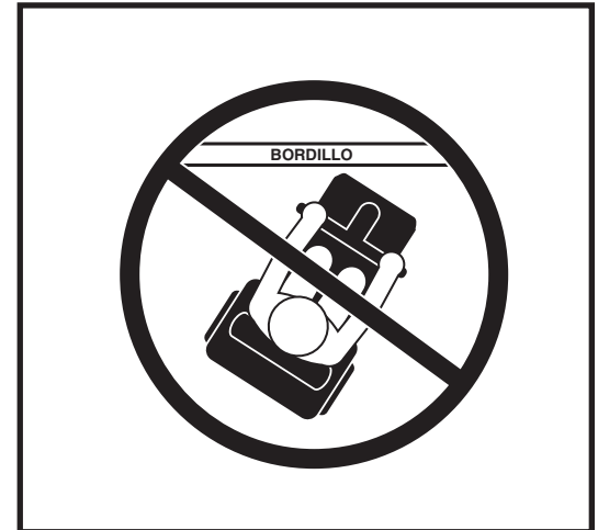
Figura 7. Modo incorrecto de subir/bajar un cordón
