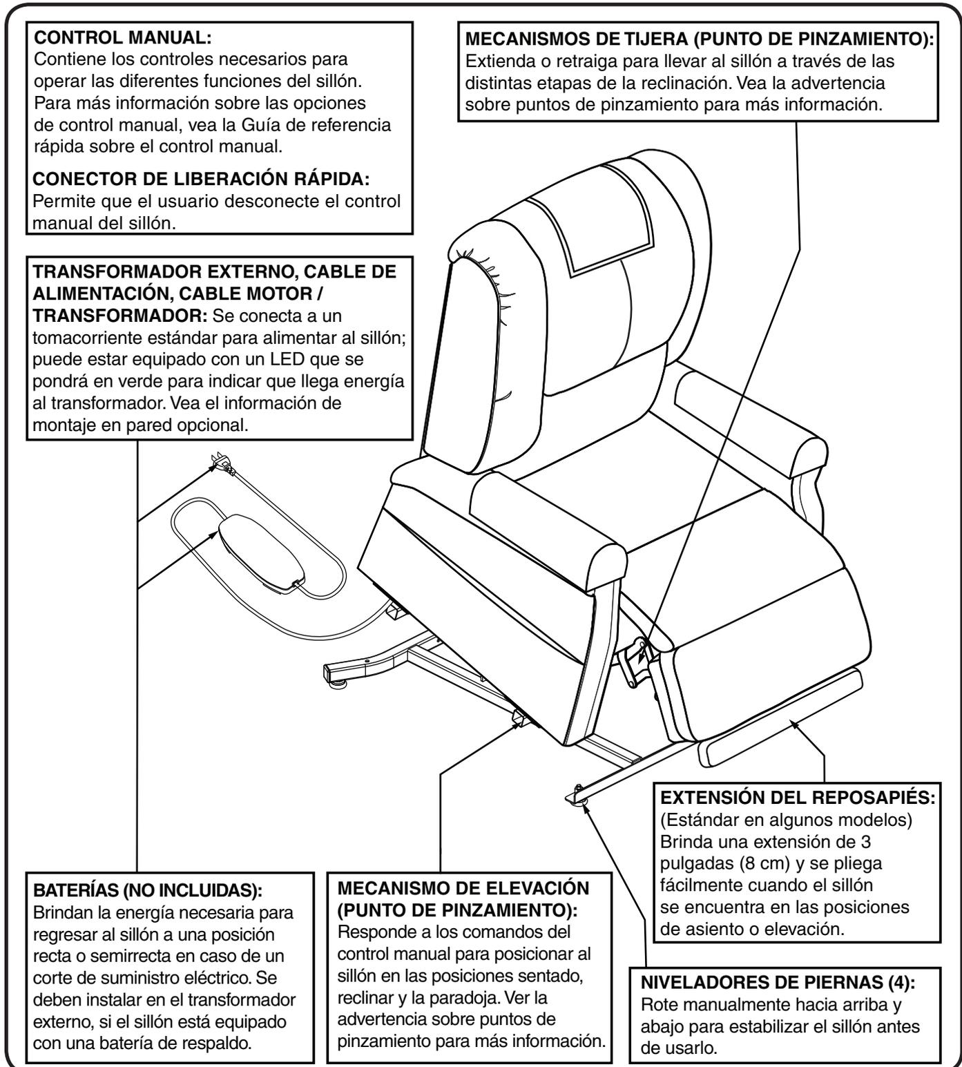
Figura 3.1 Componentes principales del sillón
