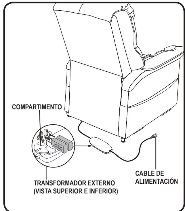
Figura 4.3 Ubicación del sistema de reserva de seguridad
